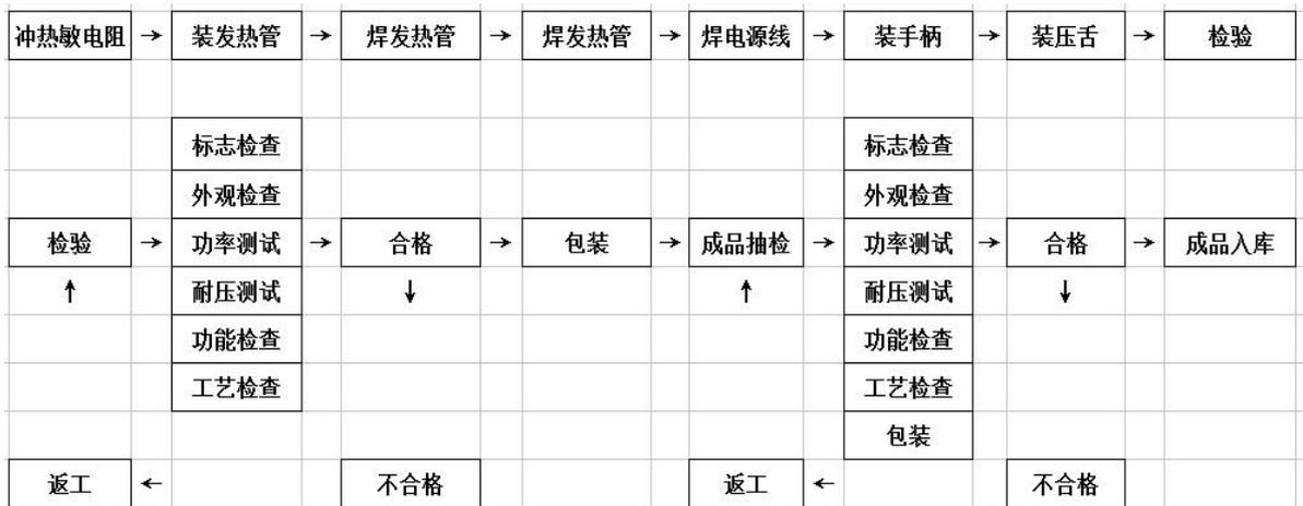
图 9 项目卷发器组装流程图
