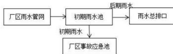
图 1 初期雨水收集池系统示意图
