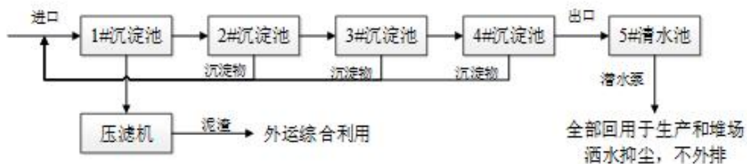
图 2.6-2 项目生产废水处理工艺流程图
